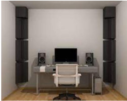
Instalación de trampa de graves
